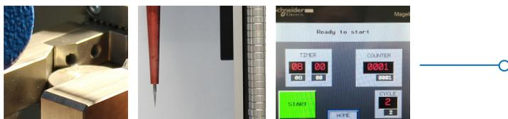
Die Ultraschallmaschine **BD 140 VGA evo2** wurde entwickelt um einen konstanten und präzisen Prozess für das Formen und Polieren von Diamant Ziehsteinen im Ziehwinkel herzustellen. Der vollautomatische Ablauf ermöglicht **ohne Bediener Einsatz 30 - 40 Ziehstein herzustellen.**
