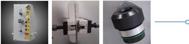
Die Drahtpoliermaschine RF 15 ist eine Ergänzung zu Balloffet Ultraschallmaschinen für große Durchmesser (insbesondere für Rod Break Down-Ziehsteine). Sie wurde entwickelt, um ohne Vibrationen die Ovalität zu reduzieren, ohne die Geometrie und die hochglanzpolierte Oberfläche des Ziehkanals zu beeinträchtigen. Das Kalibrieren zusammen mit dem Diamantpulver wird dank der Kombination aus hin- und hergehender Drahtbewegung, Rotation und Oszillation der Ziehsteine erreicht.
