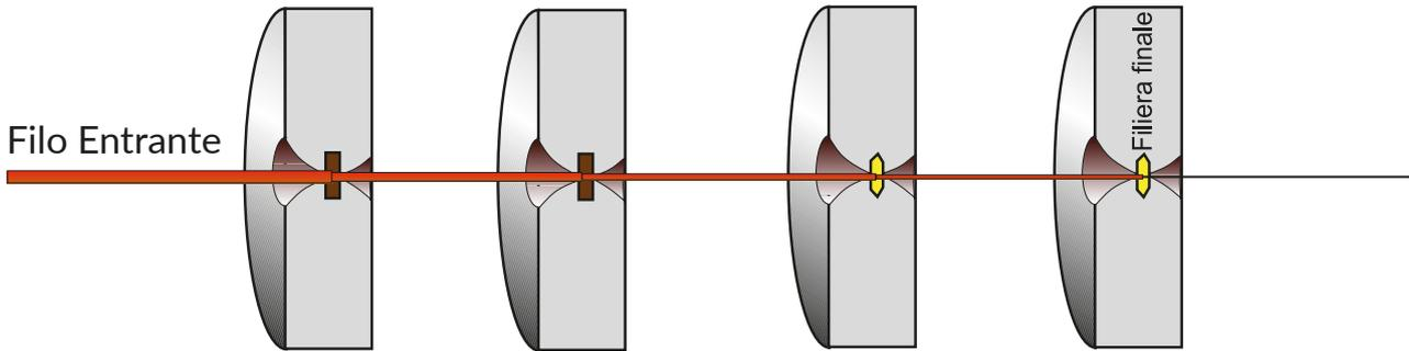
Nell'operazione di trafilatura, ad ogni passo nella filiera, il filo subisce una riduzione di diametro e quindi di sezione. Contemporaneamente questa riduzione di sezione è compensata da un aumento della lunghezza del filo. Quest'aumento si chiama «allungamento»
