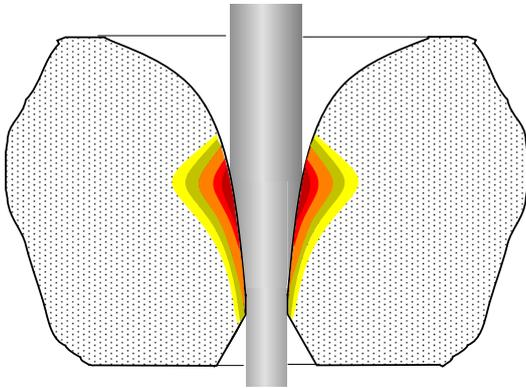
La filiera si scalda in modo diverso seconda l'angolo del cono di trafilatura.
