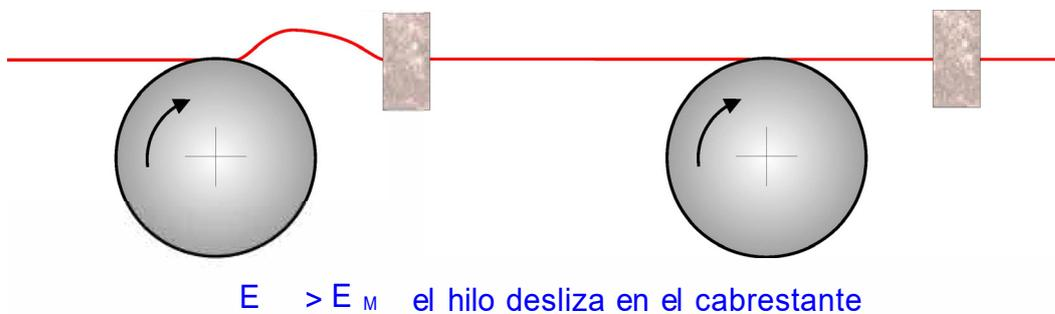
Elongación entre hileras demasiado alta respecto a la elongación máquina, provocando un deslizamiento fuerte del hilo sobre el cabrestante => Desgaste prematuro del cabrestante y daño a la calidad del hilo
