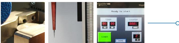
La machine BD 140 VGA evo2 a été développée pour le formage et le polissage précis et constant des angles des filières diamant. Elle permet d'usiner automatiquement 30 à 40 filières sans intervention de l'opérateur.
